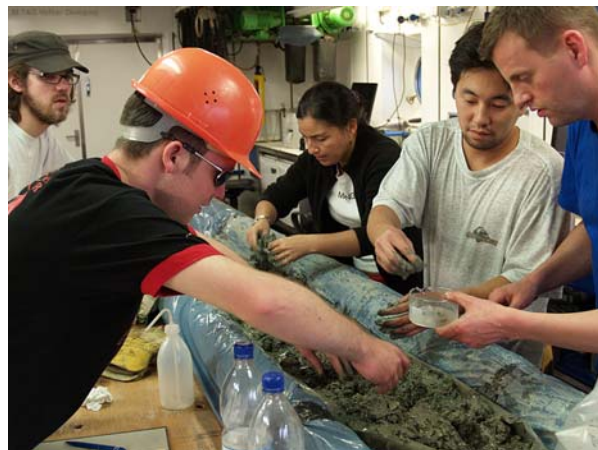
Abbildung 1: Das unverzichtbare Gerät bei Arbeiten in der Sauerstoffminimumzone: die CTD mit Wasserschöpfer-Rosette (links). Bei den Arbeiten an Gashydratkernen kommt es auf eine schnelle Bearbeitung im Sedimentlabor an, da sich die Gashydrate an Bord vor den Augen der Wissenschaftler zersetzen (rechts). Photos V. Diekamp, MARUM).
