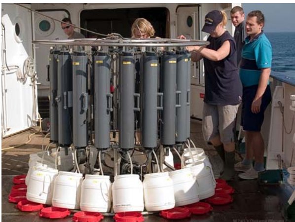
Abbildung 1: Das unverzichtbare Gerät bei Arbeiten in der Sauerstoffminimumzone: die CTD mit Wasserschöpfer-Rosette (links). Bei den Arbeiten an Gashydratkernen kommt es auf eine schnelle Bearbeitung im Sedimentlabor an, da sich die Gashydrate an Bord vor den Augen der Wissenschaftler zersetzen (rechts). Photos V. Diekamp, MARUM).
