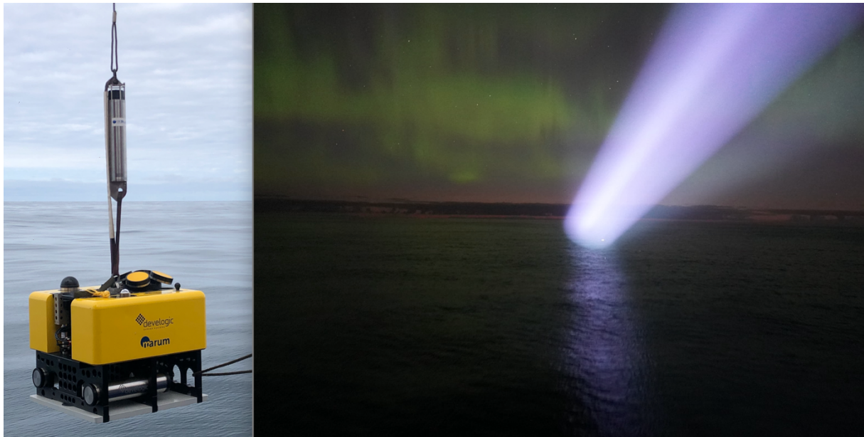
Abbildung 2 Links: MARUM Seafloor Lander beim Aussetzen unter dem Releaser. Rechts: Unter einem Himmel mit Polarlichtern taucht der Lander auf und wird mit dem starken Scheinwerfer der MERIAN „fixiert“ und nachher sicher geborgen.
