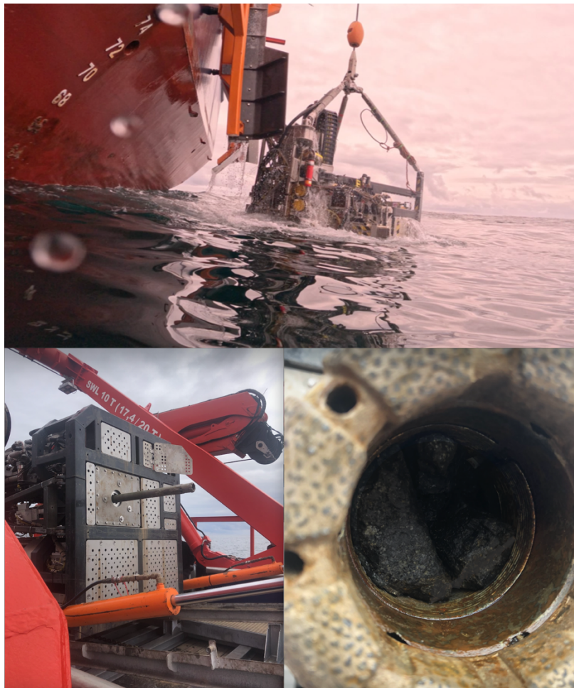
Abbildung 2 Oben: MeBo-Bergung über den A-Rahmen der MERIAN. Unten: Die letzte Bohrstange des Bohrgeräts konnte nicht im Gerät verstaut werden (links), weil Basalte das Kernrohr blockierten (rechts).
