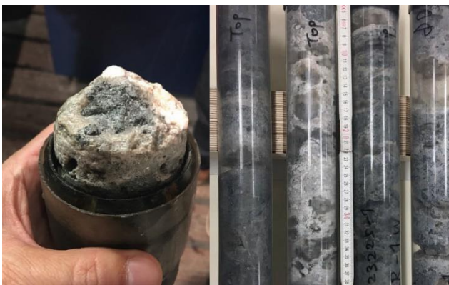
Abbildung 1: Ausschnitte der Kalksteinbohrkerne, die im Seep-Gebiet des Four-Way-Closure-Rückens mit dem MeBo erbohrt wurden. Die Datierung dieser Gesteine wird Aussagen zur Entwicklung der Seepaktivitäten ermöglichen (© Andrew Lin).
