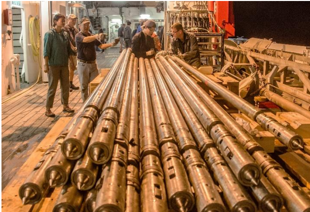
Abbildung 3: Nach dem Einsatz von MeBo200 werden an Deck die Kernrohre aus den Magazinen genommen und für die Wissenschaftler aufgestapelt. Zuerst wird eine Sedimentprobe zur Bestimmung der Gase genommen, bevor die mit Sediment gefüllten Liner aus den Kernrohren herausgezogen werden (© Paul Wintersteller).
