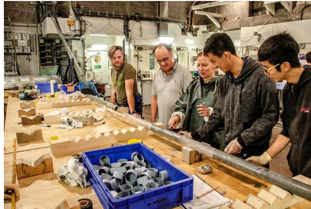
Abbildung 4: Durch die Druckentlastung der Sedimentkerne im MeBo beim Aufstieg in der Wassersäule und im Labor sowie durch Gashydratzersetzung dehnen sich Gasblasen aus, so dass Lücken in den Sedimentkernen entstehen. Diese werden von den Wissenschaftlern bei der Bearbeitung der Kerne berücksichtigt (© Paul Wintersteller).
