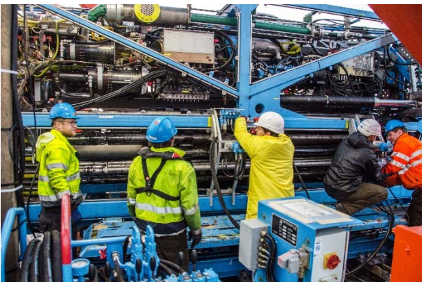
Abbildung 3: Seitenansicht des MeBo200 nach der ersten Bohrung der M142. Die Herausnahme der Kernrohre aus dem Magazin geschieht mit Hilfe einer speziell konstruierten hydraulischen Be- und Entlade-Einheit (© P. Wintersteller).
