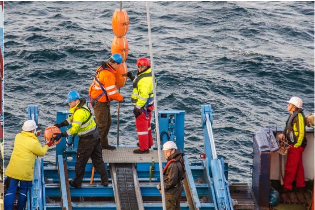
Abbildung 2: Über dem MeBo200 wird der mit Glasfasern ausgerüstete Spezialdraht mit Auftriebskörpern bestückt, welche am Meeresboden dafür sorgen, dass der Draht nicht auf dem Meeresboden fällt (© P. Wintersteller).
