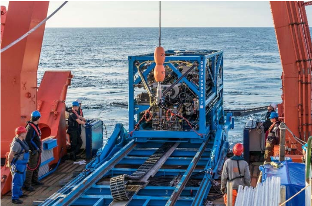
Abbildung 1: MeBo200 wird über den A-Rahmen der METEOR zu Wasser gelassen. Das moderne Launching-System sorgt für ein sicheres Aussetzen des Großgerätes (© C. Rohleder).
