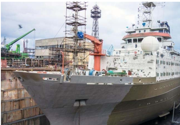
Abbildung 1: Forschungsschiff METEOR im Trockendock der Werft in Varna. Nachdem der Rumpf des Schiffes im Sandstrahlgebläse bis auf den nackten Stahl gesäubert war, wurde eine Bronze-Grundierung aufgetragen (© Heike Duggen).
