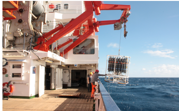
Die CTD mit Rosettenwasserschöpfer wird nach erfolgter Probennahme in bis zu 1000 m Tiefe wieder eingeholt. [Foto: Lisett Kretzschmann]
