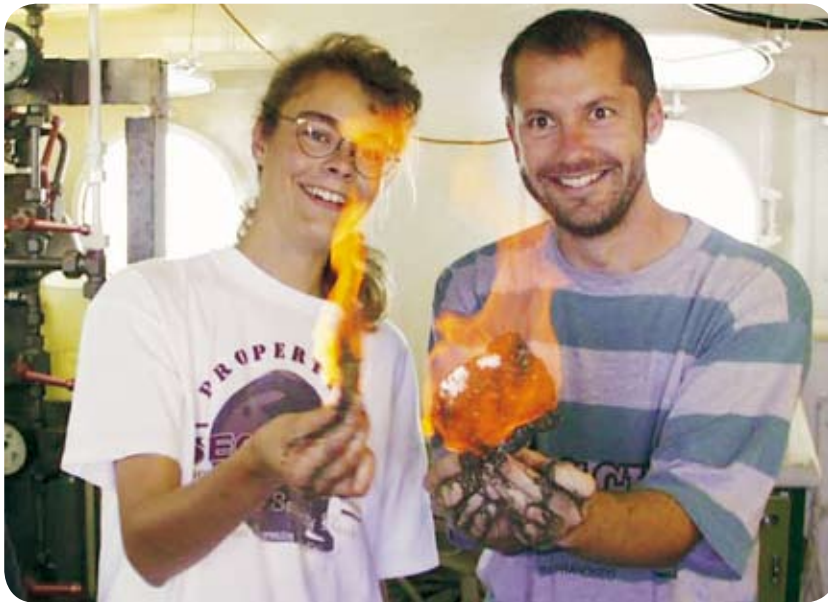
Abb. 1: Brennendes Eis. Gashydratbrocken an Bord eines Forschungsschiffes kurz nach ihrer Bergung vom Meeresboden. Die Gashydrate werden instabil und zerfallen zu Wasser und Methan. Das frei werdende Methan entweicht und verbrennt mit konstanter Flamme, wenn es entzündet wird.
