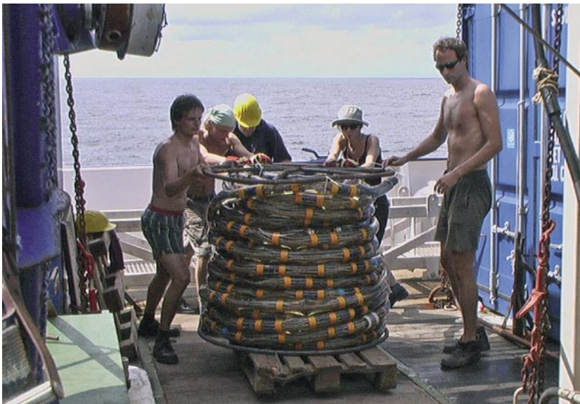
Die Fotos zeigen das Vorbereiten und Ausbringen des seismischen Streamersystems auf dem Forschungsschiff METEOR. In der Mitte ein seismisches Profil über mehreren Gasaustritten vor der Kongo Mündung (Afrika). Eine pockennarbige Morphologie markiert die Austrittsstellen für Gas und Wasser.
